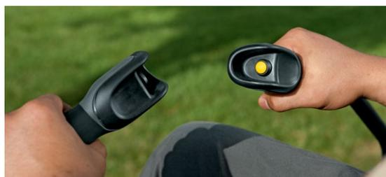
**Une maîtrise inégalée** et une commande simple grâce aux manettes à revêtement en mousse. Pour relever/abaisser le carter de coupe et désengager les lames, il suffit d'appuyer sur un bouton.
