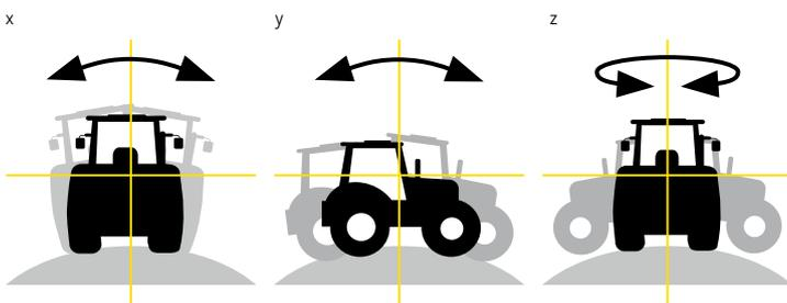
La fiabilité sur tous les terrains – Le module de compensation du terrain (TCM) détecte et évalue les mouvements parasites du véhicule sur les 3 axes x, y et z, pour un positionnement parfait au sol, quelle que soit la nature de la parcelle.
